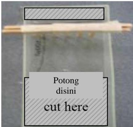
6. Kawat stainless atau tembaga diatur sebagai elektroda negatif pada bagian atas gel dan elektroda positif pada bagian bawah gel.
